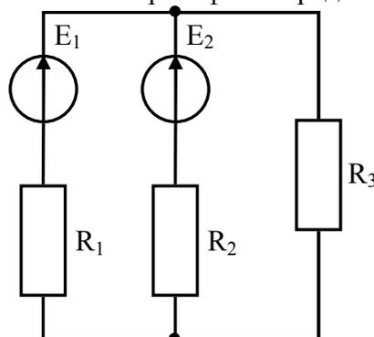
3. В цепи изображенной на рисунке:  $E_1 = 3 \text{ В}$ ,  $E_3 = 6 \text{ В}$ ,  $R_1 = 1 \text{ Ом}$ ,  $R_2 = 2 \text{ Ом}$ ,  $R_3 = 1 \text{ Ом}$ . Найдите токи  $I_1$ ,  $I_2$ ,  $I_3$ , используя метод контурных токов.
