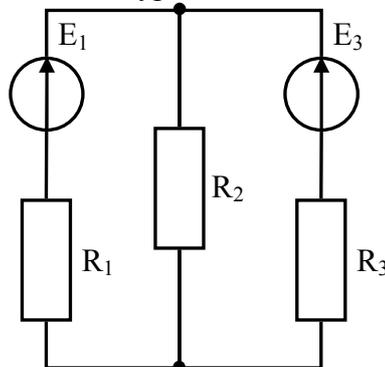
4. Используя метод контурных токов, определить токи в ветвях схемы, изображенной на рисунке 2, если  $E_1 = 4 \text{ В}$ ,  $E_3 = 6 \text{ В}$ ,  $R_1 = 20 \text{ Ом}$ ,  $R_2 = 40 \text{ Ом}$ ,  $R_3 = 20 \text{ Ом}$ .
