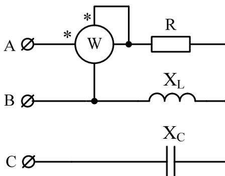
Определите показание ваттметра.
